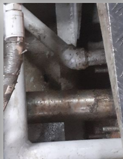
- Conserto e troca da gaxeta do eixo do motor de boreste
