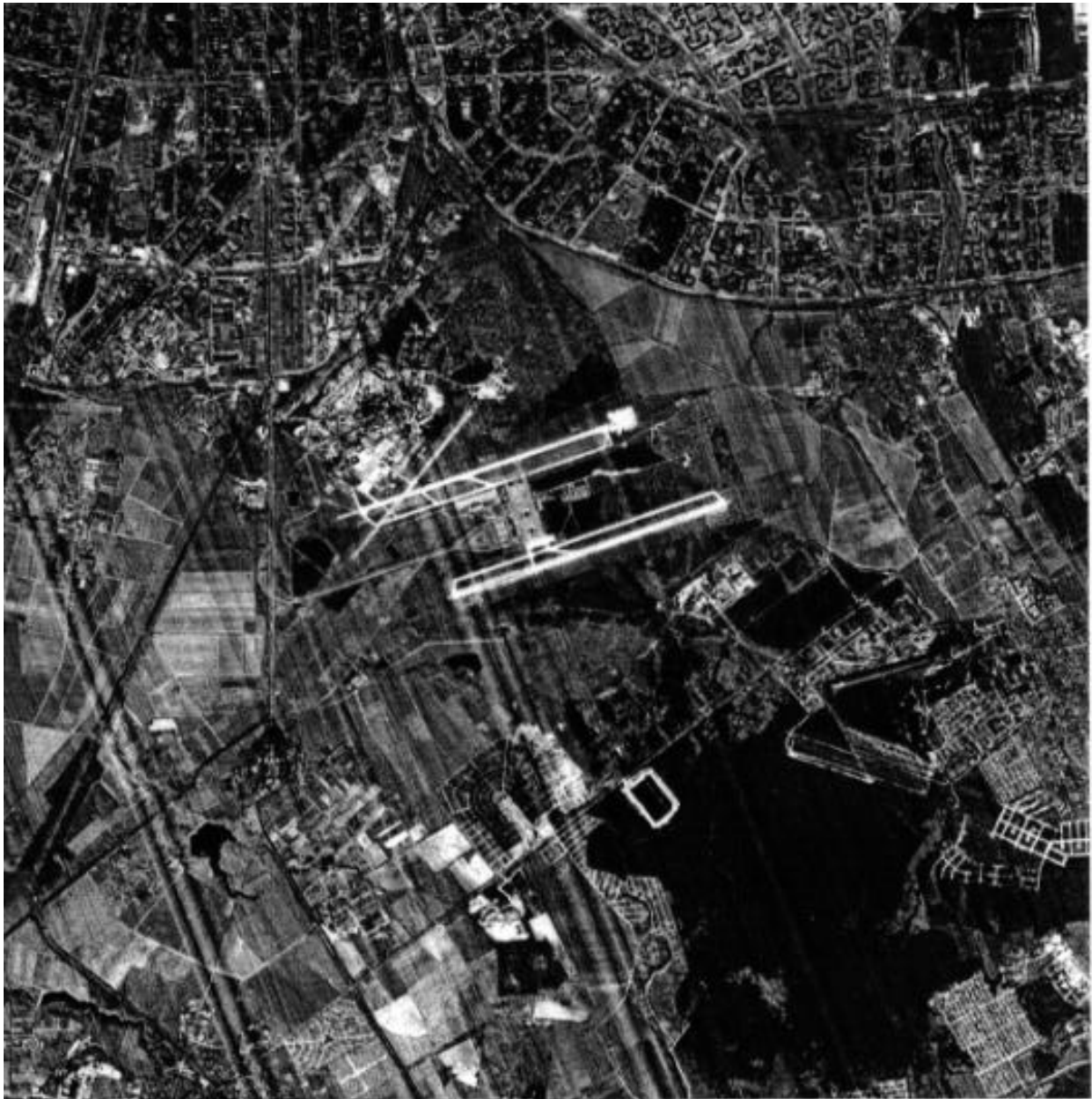
Fig. 8: Satélite indiano IRS 1C: Aeroporto de Munique, Alemanha. Tamanho do pixel no terreno: 5,8 x 5,8 m
