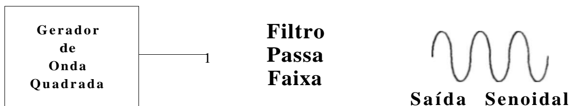
Figura 5.1: Maneira empregada na produção da onda senoidal.
