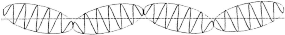
Figura 8.14: Sinal modulado, com influência de uma componente do sinal modulador, de baixa frequência, superposta
