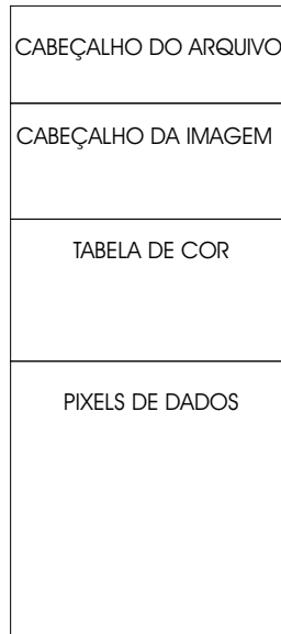
Figura 3.1: Estrutura geral do formato BMP
