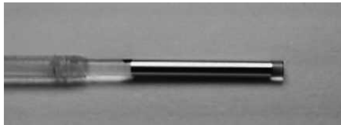
Fig. 4.2 – Foto da ponta metalizada de um sensor em fibra multimodo.
