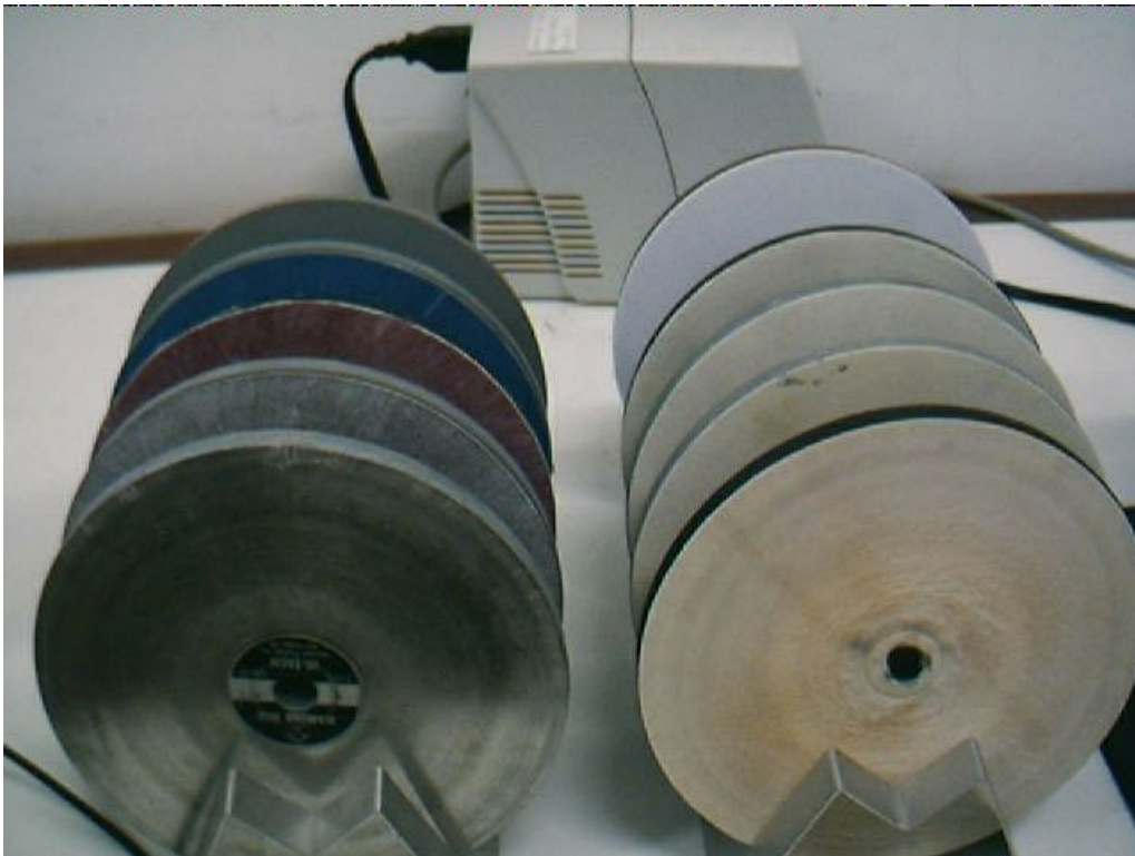
Fig. 3.4 – Conjunto de discos utilizados pelo sistema portátil de polimento para laboratório.
