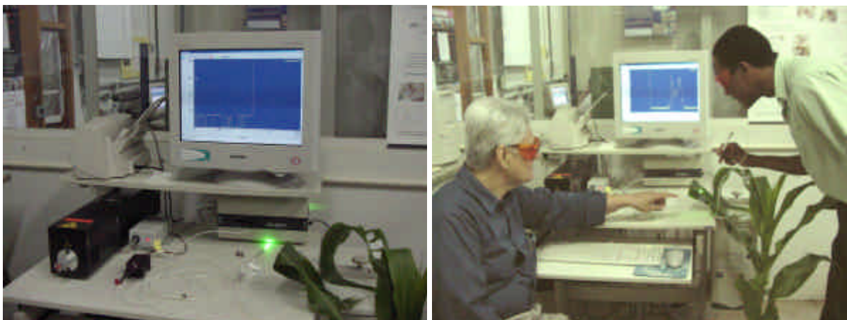
Figura 6.1 –Foto do espectrofotômetro e medição de espectros de fluorescência das folhas do milho.
