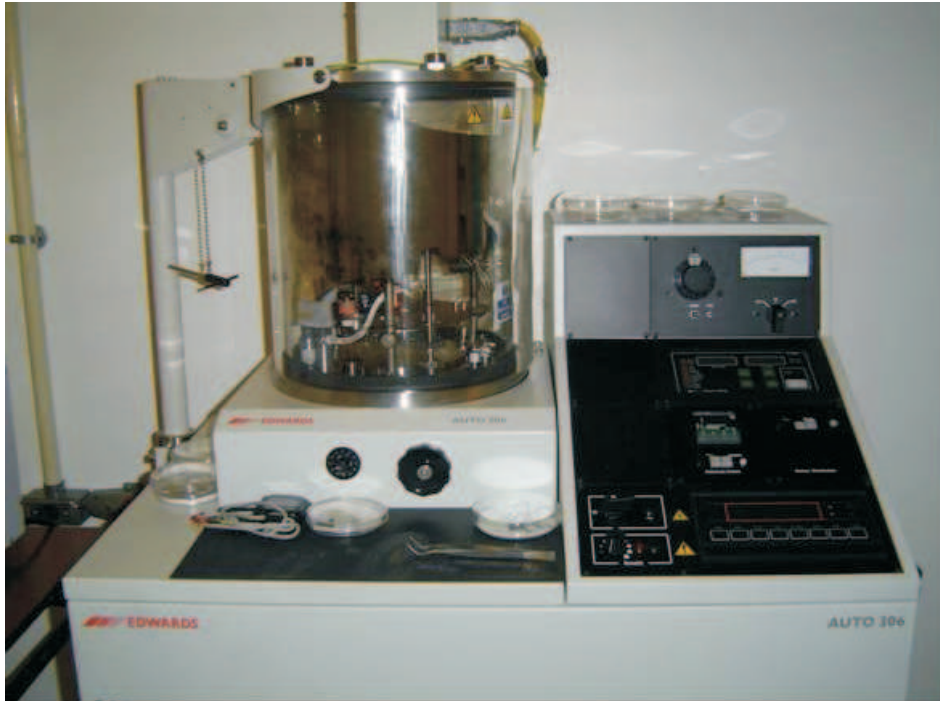
Figura 2.3: Evaporadora Edwards AUTO 306 disponível no LDN.
