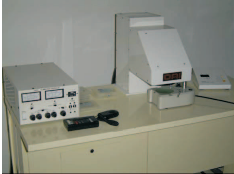
Figura 2.6: Sistema OAI modelo LS30/5 - 200W NUV do LDN.
