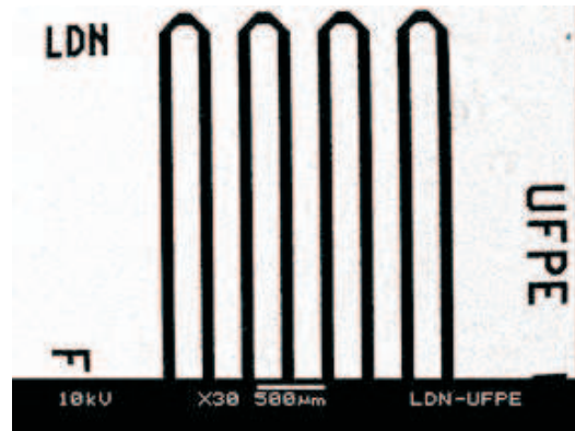
Figura 4.15: Estrutura do RTD com ampliação de 30 vezes.
