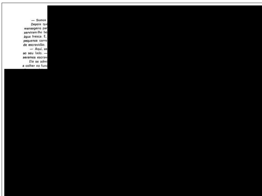
Figura 5.15: Documento da Figura 5.1 binarizado pelo algoritmo Otsu em 18 regiões.
