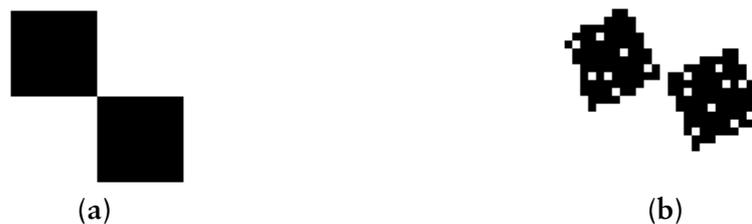
**Figura 47** - Dois quadrados pretos de 10x10 pixels aplicados ao algoritmo clássico de rotação com 25°.
