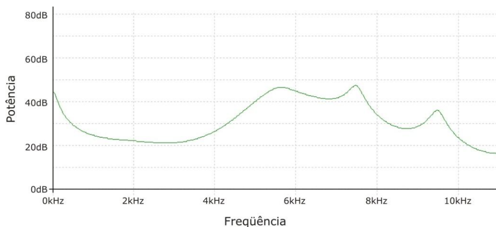
Figura A.7 – Espectro do trecho não-vocálico de fala mostrado na figura A.6.
