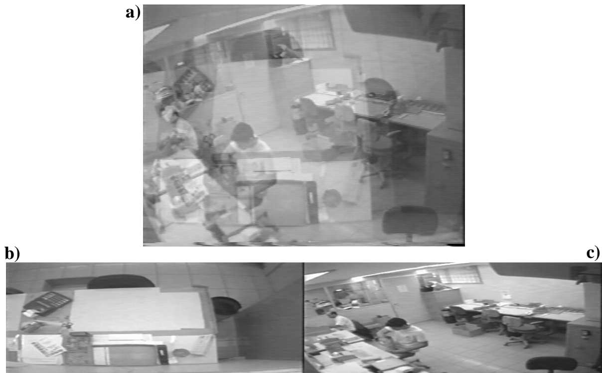
Figura 3.1: Exemplo de um quadro híbrido (a) composto por dois campos (b e c) provenientes de câmeras distintas
