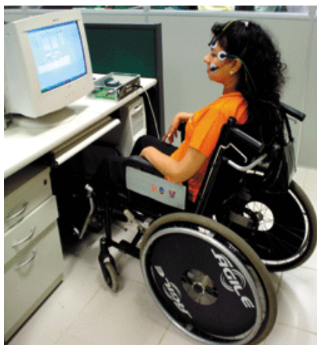
Figura 1.1 – Indivíduo utilizando equipamento de tecnologia assistiva baseado no rastreamento do globo ocular realizado por eletrodos.
