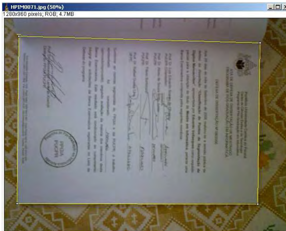
Figura A2.1 - Imagem de documento com as bordas (amarela) detectadas automaticamente pelo PhotoDoc.
