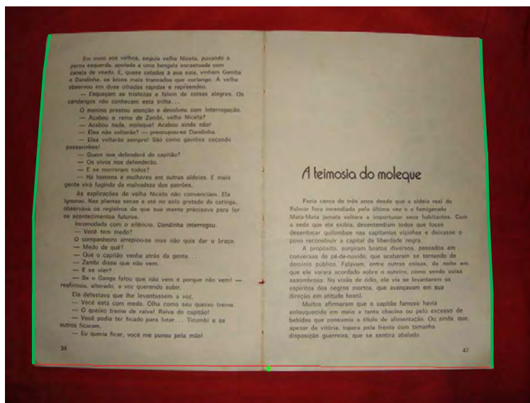
Figura 9.4 - Ilustração da distorção geométrica.
