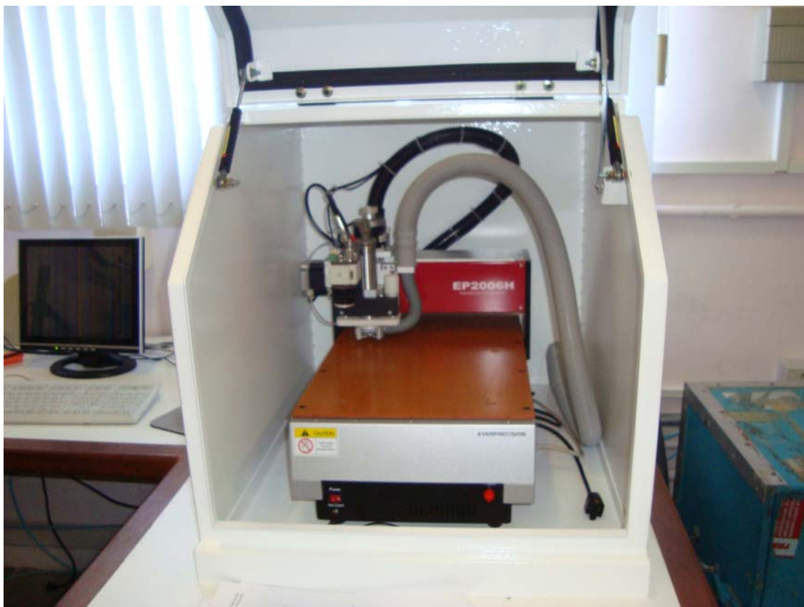
Figura 4.7 – Máquina de protótipo de placa de circuito impresso utilizada na fabricação dos interferômetros.
