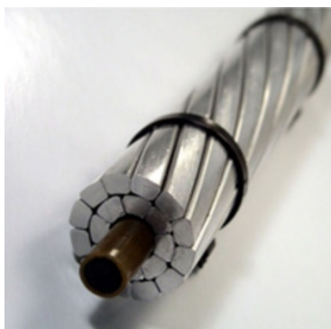
Figura 3.7 – Condutor de alumínio com alma de compósito [71].
