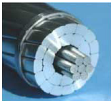
Figura 3.4 – Fotografia do condutor tipo gap de liga de alumínio ultra termorresistente reforçado com aço [63].
