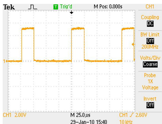
Figura 3.5. Sinal de ativação (modulação) dos LEDs, gerado pelo microcontrolador.
