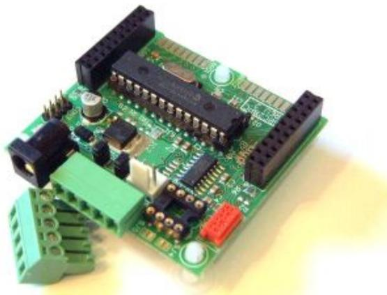
Figura 2.4: Ilustração da placa de desenvolvimento SBC28PC.
