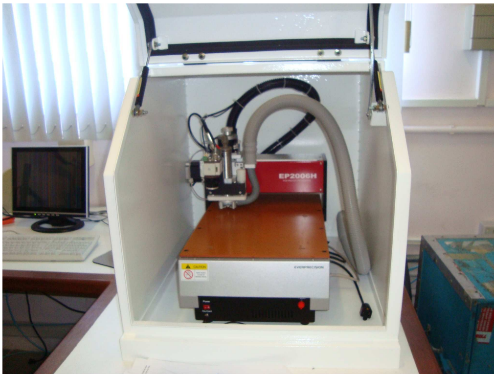
Figura 6.14: Máquina para prototipação de placas de circuitos impressos utilizada na fabricação do duplexador.
