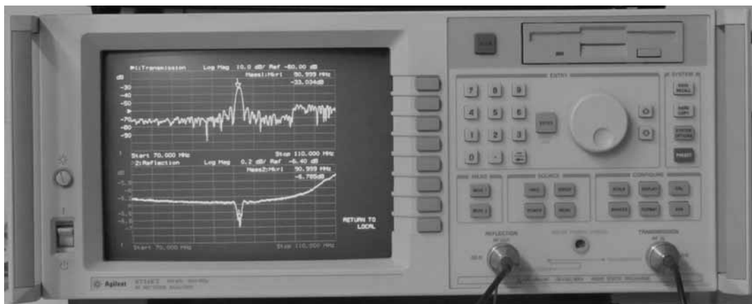
Figura 4.1: 8714ET - RF Network Analyzer usado na caracterização dos dispositivos OAS.
