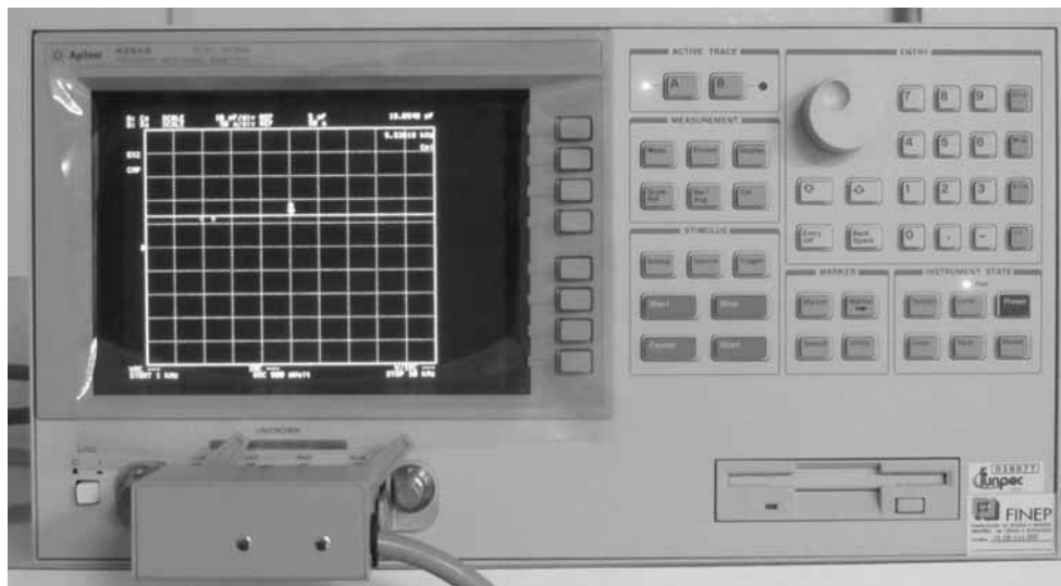
Figura 4.10: 4294A - Precision Impedance Analyzer da Agilent usado na medição das capacitâncias estáticas das estruturas interdigitadas.
