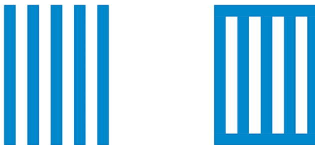
Figura 2.9: Tipos comuns de estruturas refletoras: com eletrodos flutuantes (esquerda) e com eletrodos em curto (direita).
