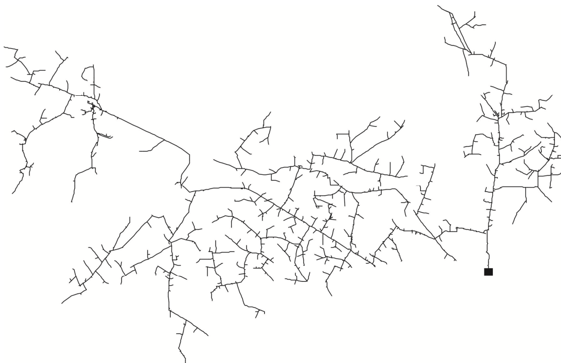
Figura 7.1 – Representação do alimentador CPS-01L7 da regional Caruaru.
