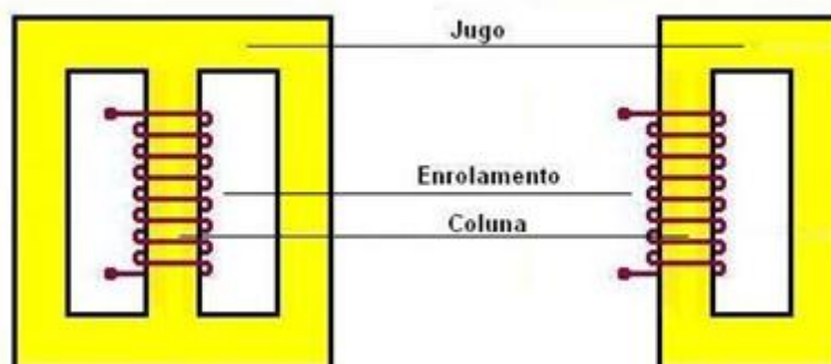
Figura 3.5 – Estruturas eletromagnéticas individuais por fase.
