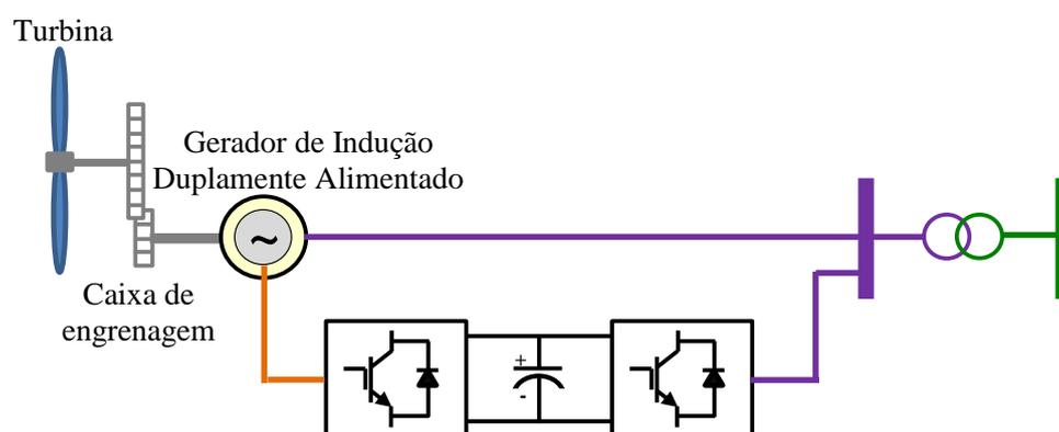
Figura 2.4: Configuração Gerador de Indução Duplamente Alimentado
