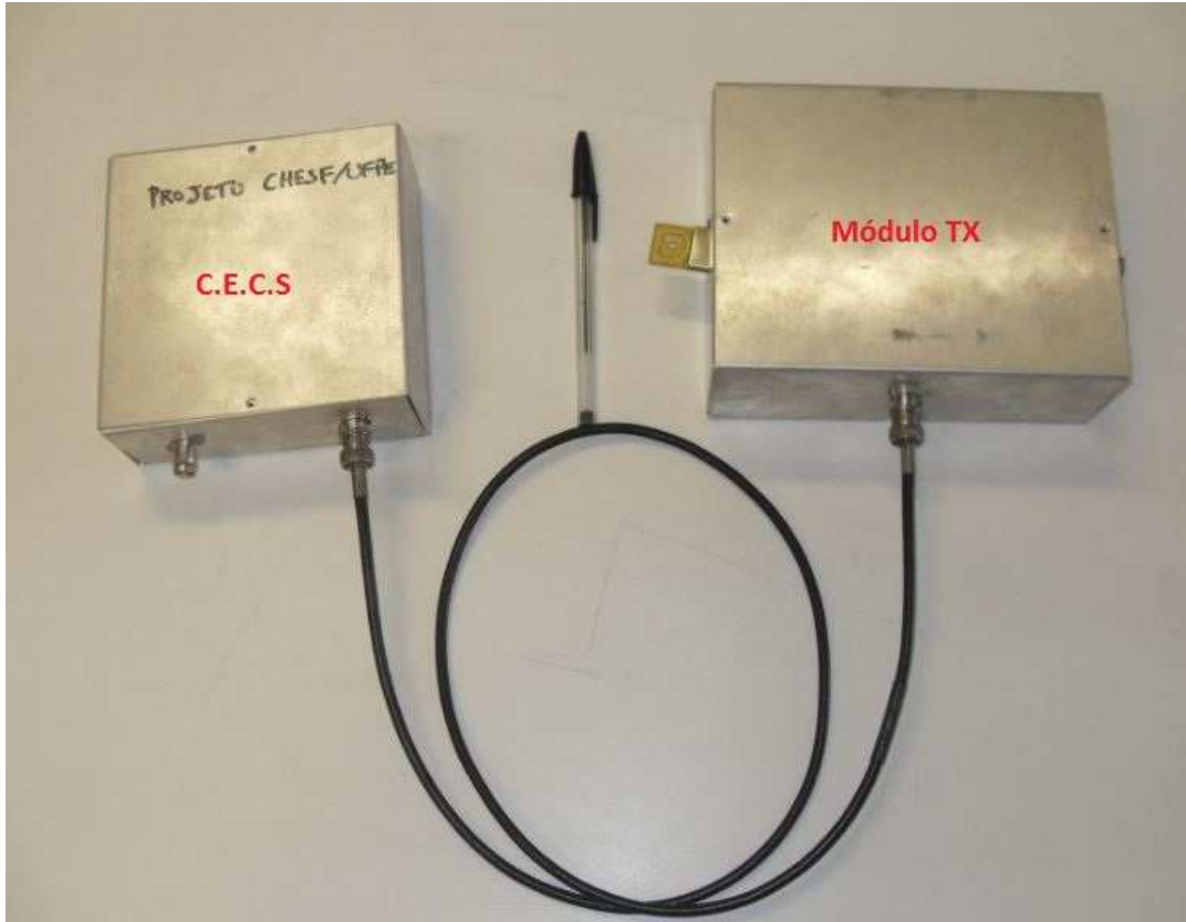
Figura 76 – Módulo TX e C.E.C.S. utilizando caixa metálica e cabos coaxiais.
