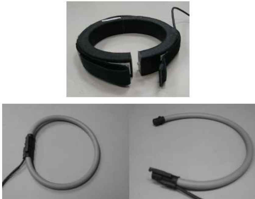
Figura 34 – Bobinas de Rogowski destacáveis.
