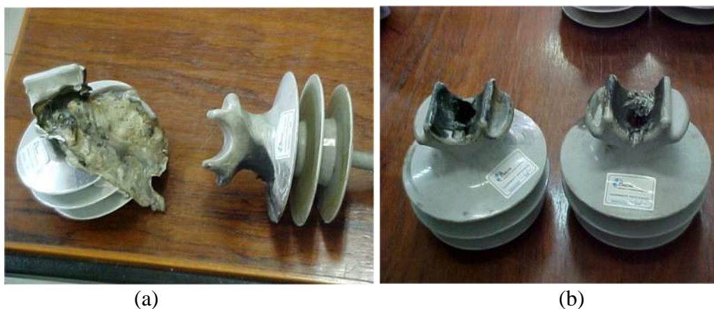
Figura 1.2 – Isoladores poliméricos que apresentaram problemas após poucos meses em operação. Fonte: fornecida pela Celpe.
