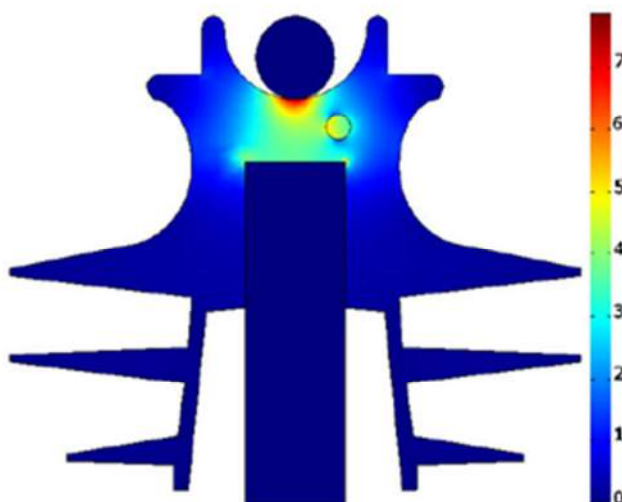
Figura 4.8 – Distribuição de campo elétrico a 1 pu (kV/cm). Fonte: (FAGUNDES, 2008).
