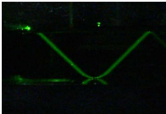
**Figura 3.6** – Deflexão de luz laser de 532nm em solução não-homogênea de açúcar. Fonte: <http://physicsed.buffalostate.edu/pubs/StudentIndepStudy/EURP09/Sugar/SugarB.jpg>
