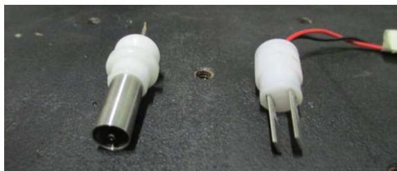
**Figura 6.13** – Foto das geometrias de célula de medição usadas para medição de espectroscopia de impedância.
