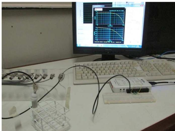
**Figura 6.3** – Equipamento de espectroscopia de impedância construído no DES em Recife, PE
