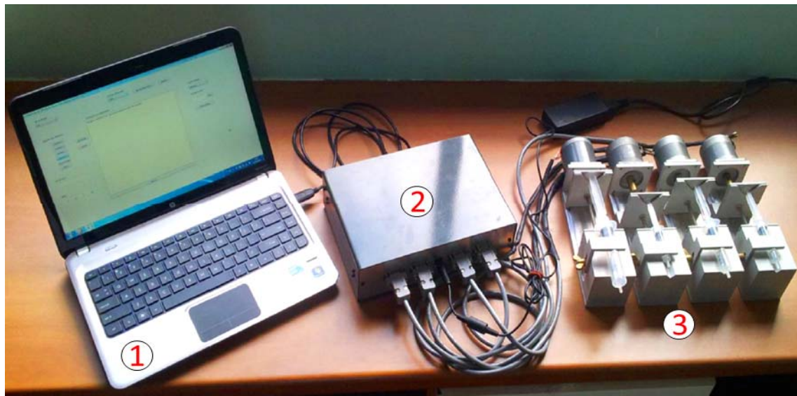
Fig.22 Foto ilustrativa do sistema de infusão. 1. notebook com interface gráfica criada em Qt Creator, 2. módulo de potencia controlado por um microprocessador Arduino Mega e 3. peças motorizadas com suporte para as seringas (Extraída de [Loidmann]).
