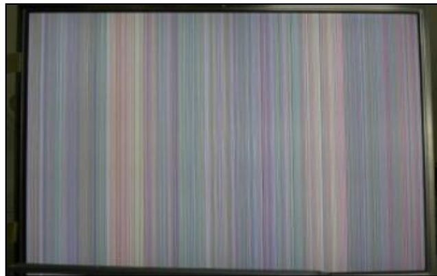
Figura 45 – Defeito de interferência na imagem no painel TFT-LCD.
