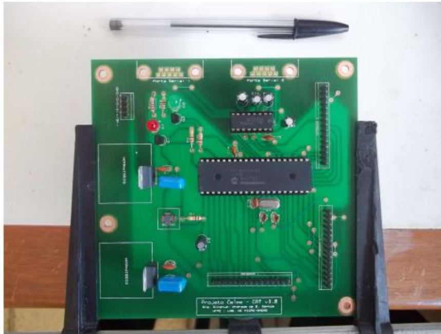
Fig. 49 – CAT versão 3 com componentes soldados.
