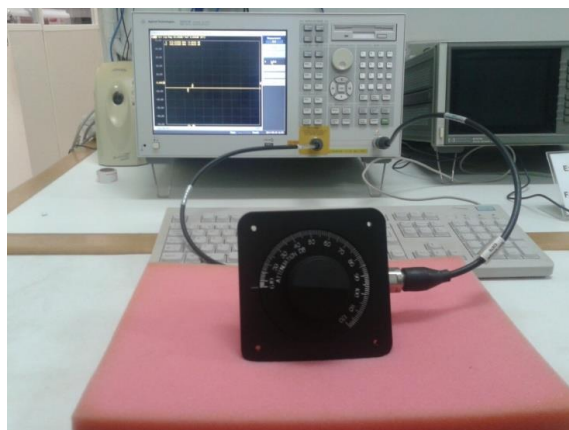
Fig. 22 – Esquema de medição para um atenuador utilizando um analisador de redes.
