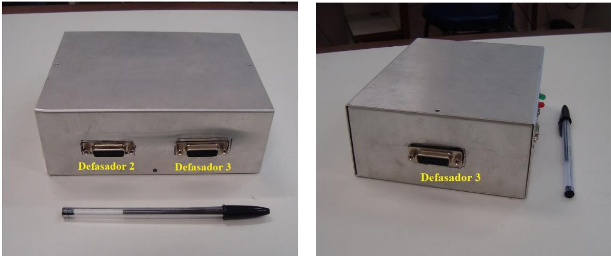
Fig. 53 – Portas para comunicação com os defasadores.
