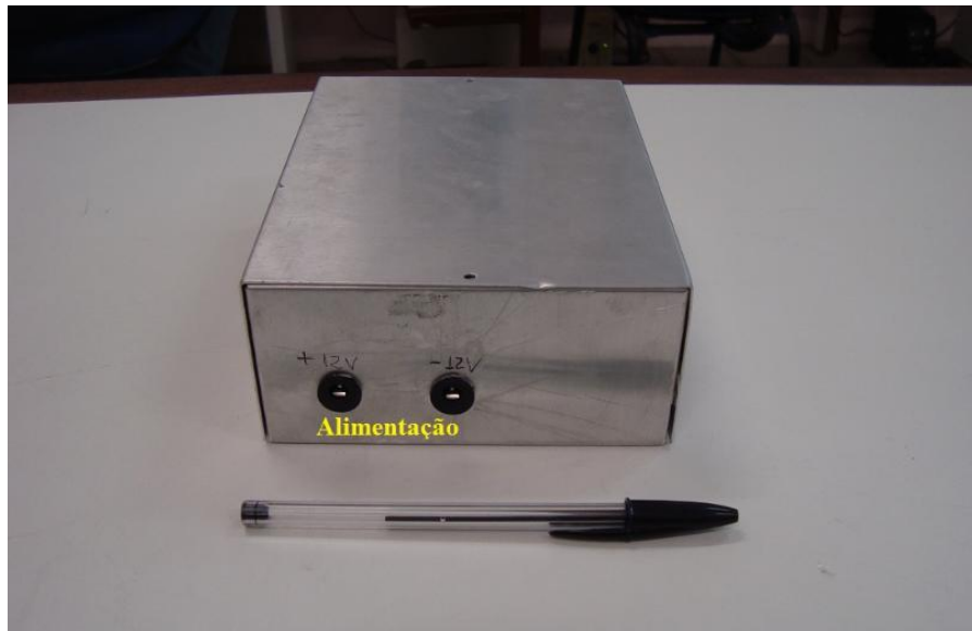
Fig. 51 – Jacks de alimentação para o CAT.
