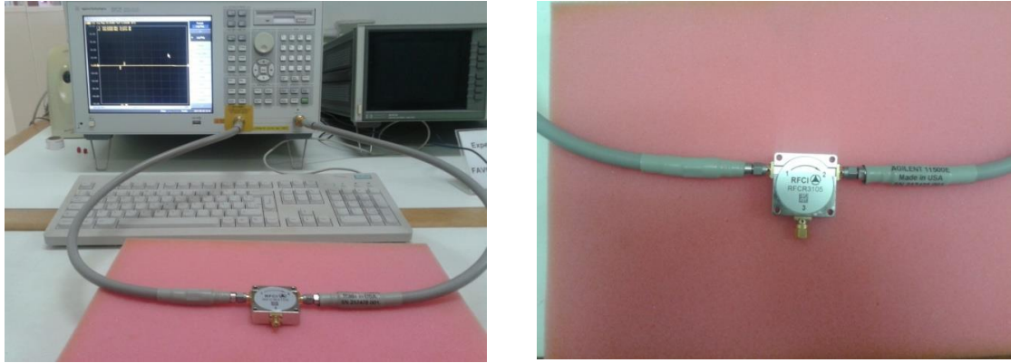
Fig. 14 – Esquema de medição para testes com os circuladores.
