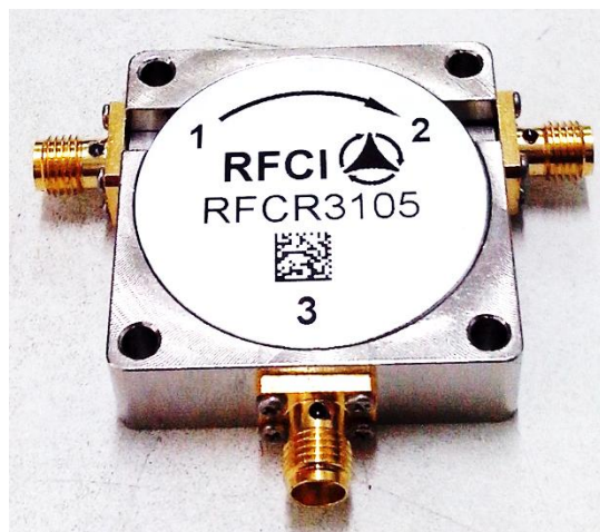
Fig. 13 – Circulador escolhido para a aplicação.
