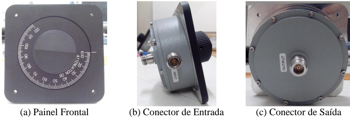
Fig. 21 – Atenuador escolhido para a aplicação.
