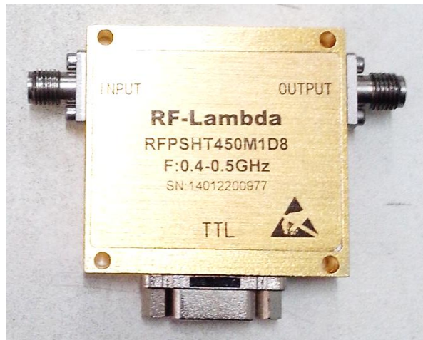
Fig. 8 – Defasador de 8 bits escolhido para a aplicação.
