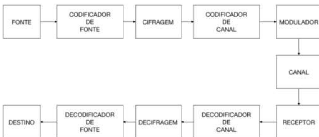
Figura 2.9: Diagrama de blocos de um sistema de comunicação digital (PIMENTEL, 2007).
