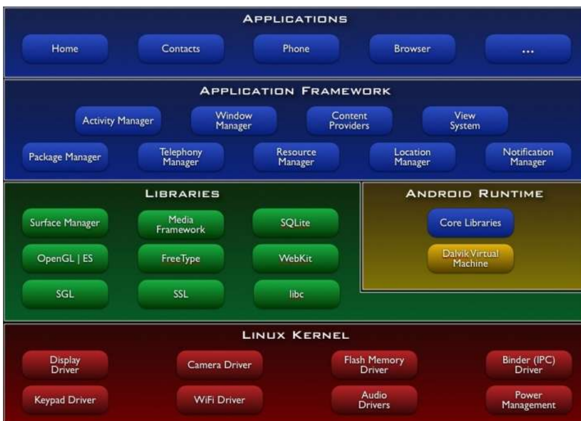
Figura B.3: Diagrama da arquitetura interna do Android.
