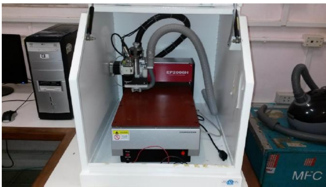
Figura 6.6 Máquina de prototipagem utilizada na fabricação dos dispositivos.
