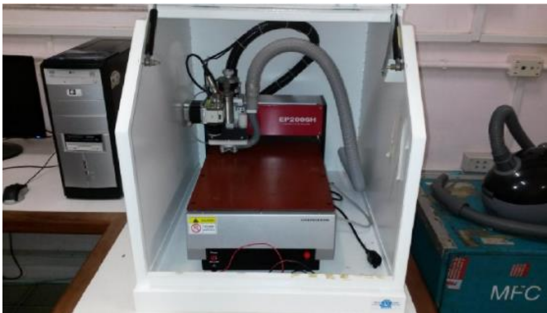
Figura 32: Máquina de prototipagem utilizada na fabricação dos dispositivos.
