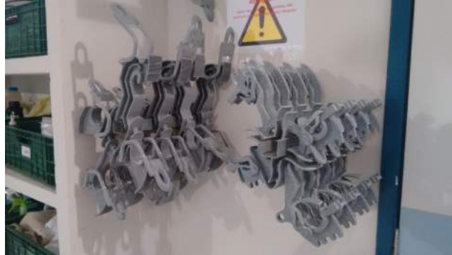
Figura 69 – Espaçadores X e Y contaminados.
