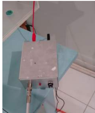
Figura 71 – Caixa de medição da corrente de fuga.
