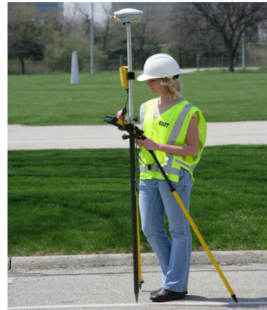
Figura 41 – Fotografia da rotina de trabalho com o dispositivo RTK
