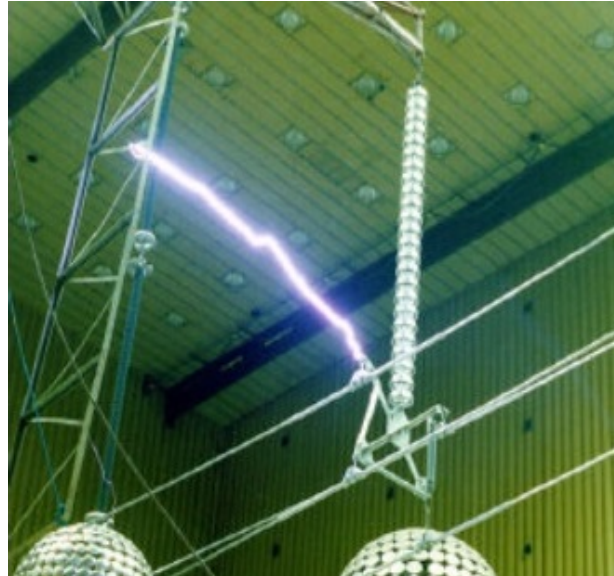
Figura 16 – Ensaio em cadeia de suspensão com quatro subcondutores com feixe expandido
