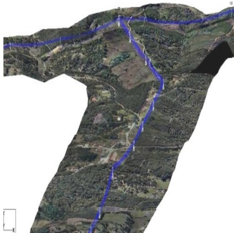
Figura 49 – Planta e perfil tridimensional em formato PLS-CADD
