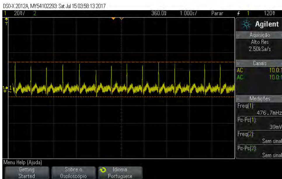
Figura 45 – Visualização do complexo QRS obtido a partir da derivação I, sem utilização das malhas
