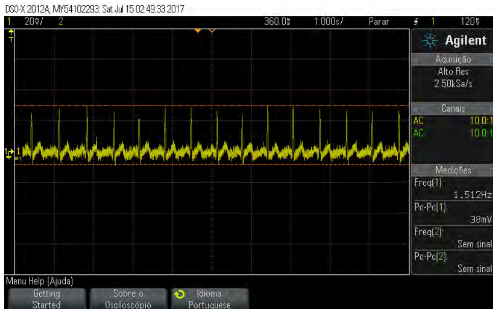
Figura 46 – Visualização do complexo QRS obtido a partir da derivação I para o circuito com aterramento das malhas
