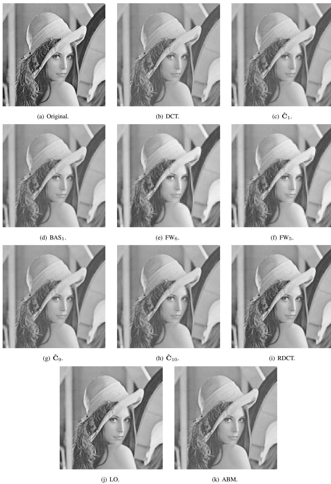
Figura B.1: Imagens comprimidas com as transformadas de comprimento 8 consideradas e r = 5 .
