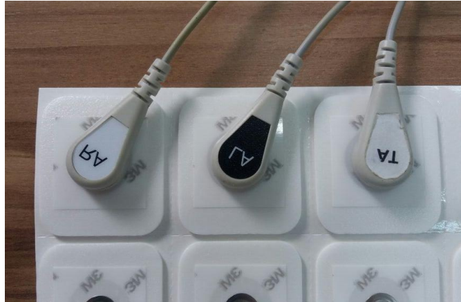
Figura 25 - Eletrodos utilizados na confecção do arranjo linear de eletrodos.
