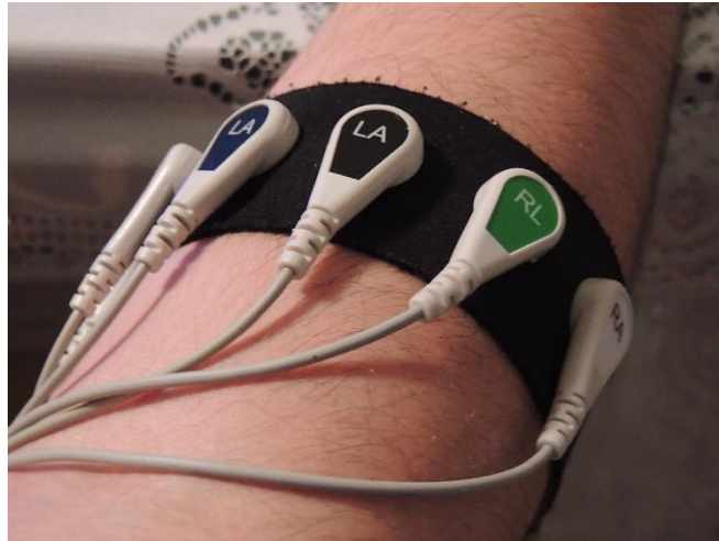
Figura 27 - Parte de frente do arranjo linear de eletrodos desenvolvido.
