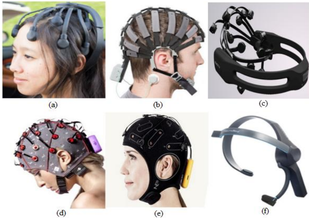
Figura 10 - Sistemas de EEG. (a) e (b): Sistemas da cognionics. (c) Emotiv Epoc (d) g.Nautilus da g.tec (e) Enobio da Neuroelectric (f) Neurosky
