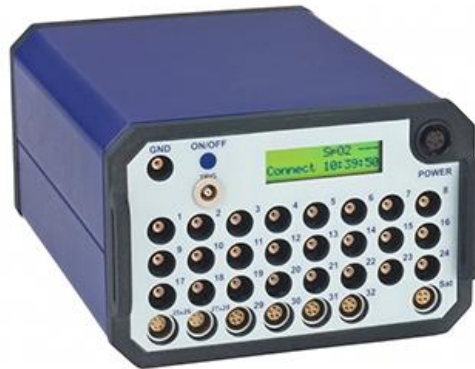
Figura 19 - Equipamento Nexus-32 da MindMedia.
