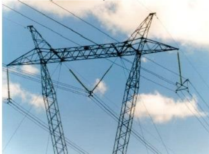
Figura 6 – Teste em campo do Feixe Expandido em 500 kV na fase direita
