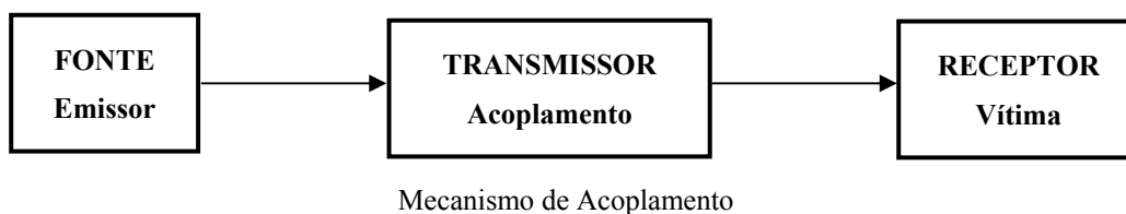
Figura 2.3: Acoplamento entre fonte e receptor de sinais eletromagnéticos.
