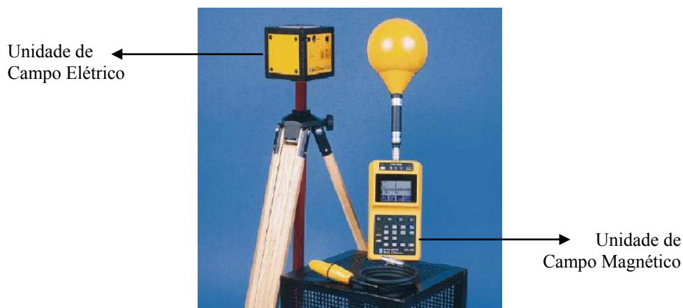
Figura 3.3: Medidor EFA-300 da Narda Measurements .
