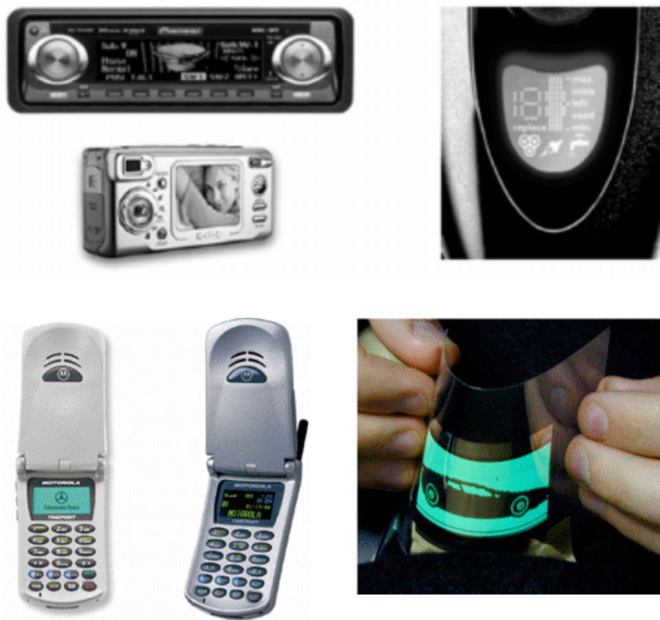
Fig. 1.6 – Exemplos de artefatos e produtos tecnológicos que apresentam painéis orgânicos embarcados. Versatilidade e baixo custo são características determinantes nas aplicações tecnológicas destacadas. No topo: à esquerda um auto-radio Pioneer com display de OLEDs; à direita, um barbeador elétrico da Philips , com display polimérico (pLEDs). No canto inferior esquerdo, dois aparelhos celulares da Motorola e, logo acima, uma câmara digital Kodak , todos equipados com visores orgânicos. No canto inferior direito, uma implementação artesanal de um painel orgânico, demonstrando a flexibilidade mecânica do dispositivo.
