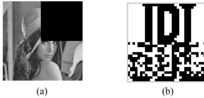
Figura 3.9: (a) Imagem marcada com 25% de sua informação destruída. (b) Marca d'água recuperada, CN = 0,8662 .
