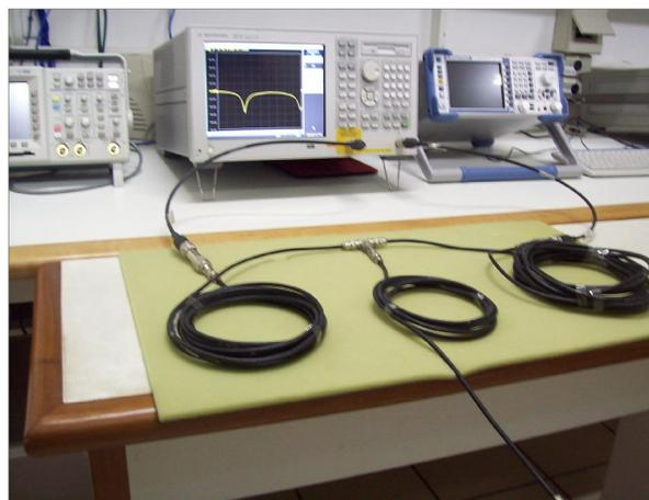
**Figura 25: Medição Realizada com Analisador de Redes**
