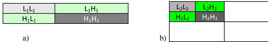
Figura 3. Esquema clássico de decomposição de imagem de acordo com o padrão 2D wavelet. Decomposição em dois níveis: a) primeiro nível. b) segundo nível.
