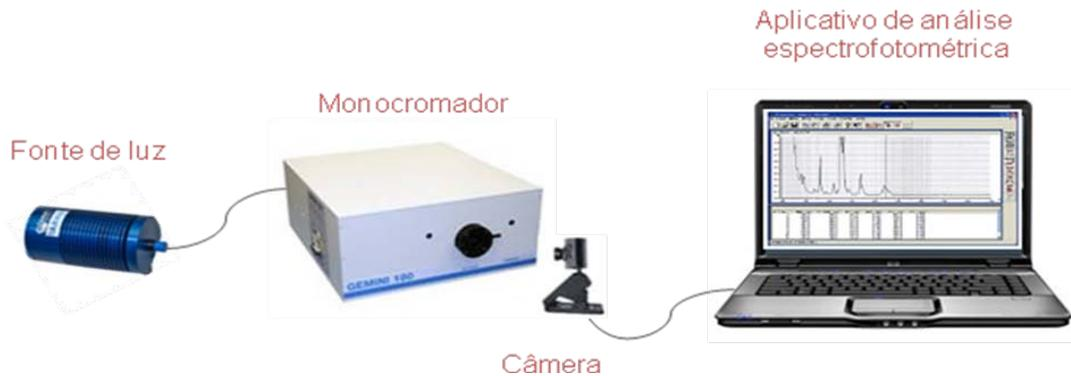
Figura 50. Conjunto para simulação de espectrofotômetro fotônico.
