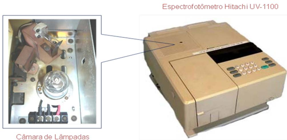
Figura 51. Espectrofotômetro óptico (HITACHI U-1100) com grade de difração convencional.
