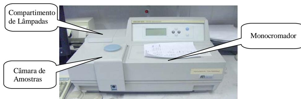
Figura 26. Espectrofotômetro convencional Spectronic 20 de uso geral.
