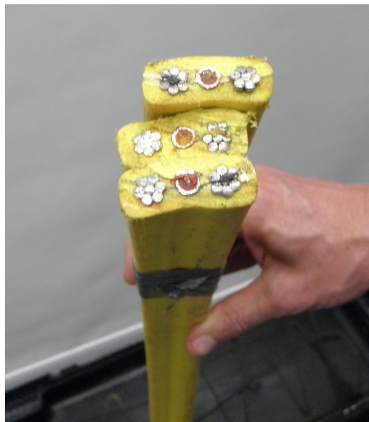
Figura B.7: Exemplo de cabo utilizado em sensores instalados em poços de petróleo. No centro tem-se uma estrutura coaxial para envio dos dados e nas extremidades cabos de aço para reforço mecânico (Cortesia CENPES/PETROBRAS).
