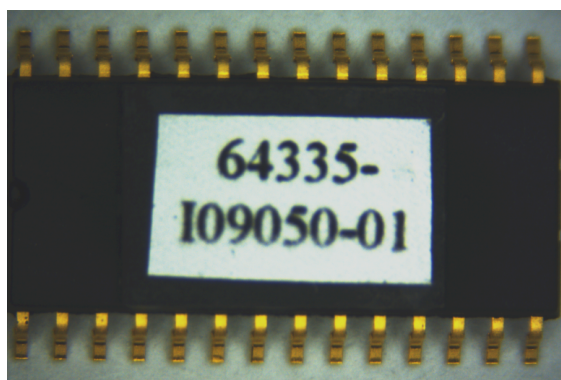
Figura 5.5: (a) Foto do chip do conversor de frequência para digital obtida por meio de um microscópio óptico. (b) Placa de circuito impresso desenvolvida para validação do chip.
