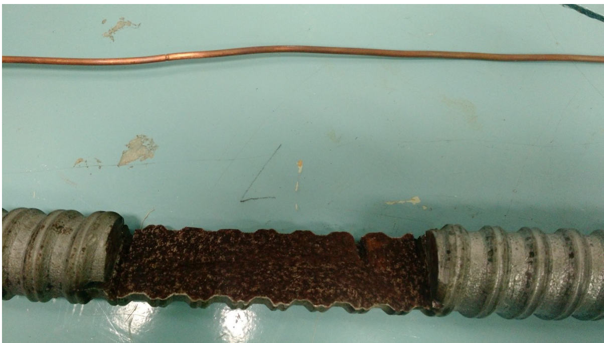
Fig. 112. Fotografia dos testes iniciais de bancada. Detalhe do desgaste realizado.
