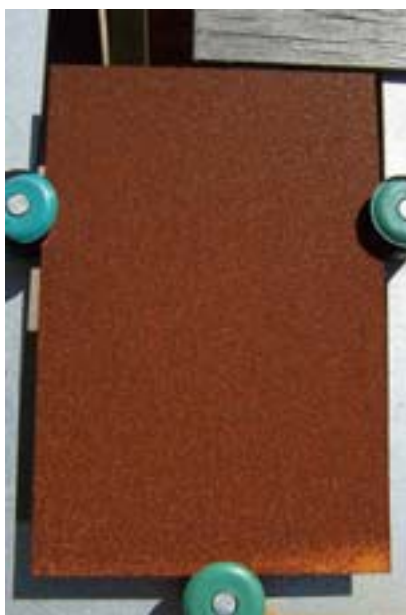
Fig. 10. Amostra de aço exposta às intempéries litorâneas. Formação de carepas.
