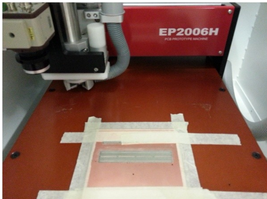
Fig. 74. Fotografia do processo de fabricação da placa do casador (após).
