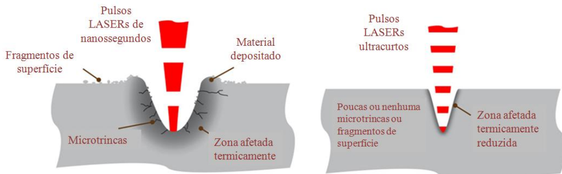
Figura 2.8: Distinção entre ablação utilizando lasers pulsados de nanossegundos (esquerda) e com pulsos ultracurtos (direita).
