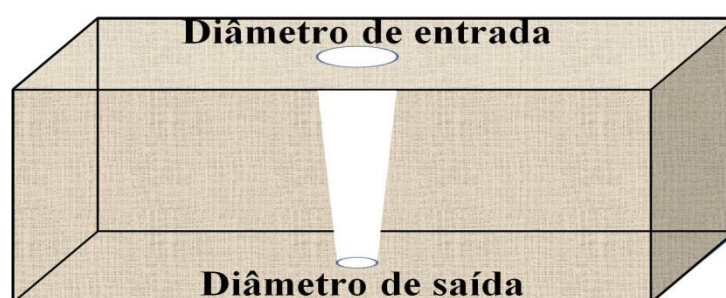
Figura 2.25: Representação dos furos de entrada e saída após perfuração.
