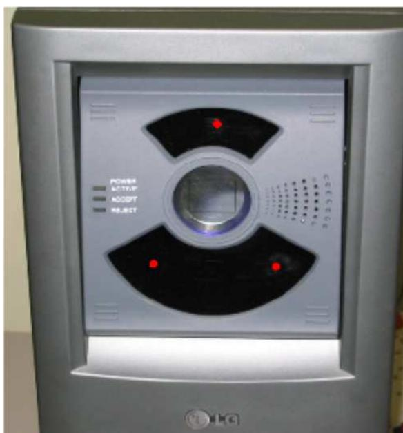
**Figura 2.1:** LG 2200 equipamento de captura da íris utilizado para gerar as imagens da base de dados NIST-ICE [1].
