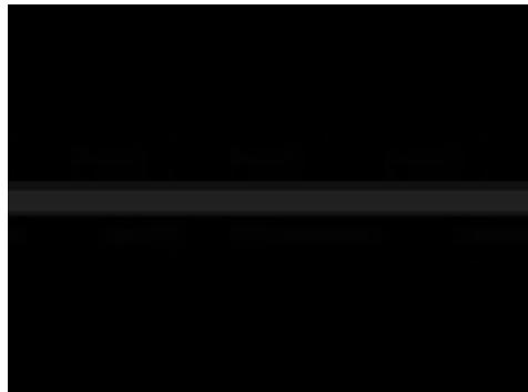
Figura 38: Imagem de um fio com diâmetro de 0,5 mm obtido com o sistema de espectroscopia THz.
