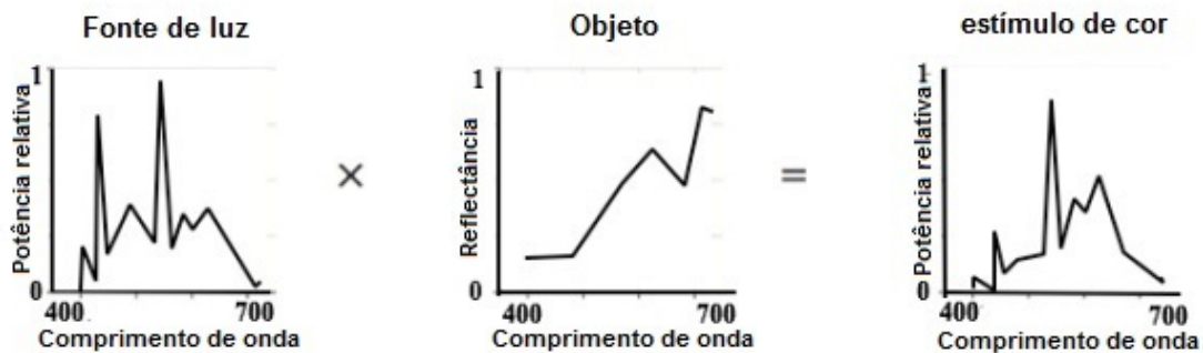
Figura 42: Esquema simplificado que ilustra como o estímulo de cor de um objeto é calculado como um produto da distribuição de potência relativa da fonte de luz e da reflectância do objeto.
