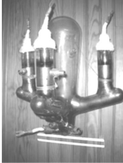
Figura 2.10 – Thyatron a vapor de mercúrio
