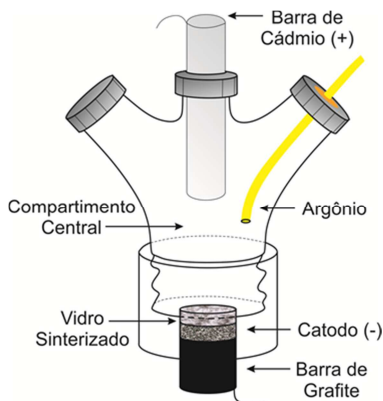
Figura 1. Célula eletroquímica de cavidade, utilizada na síntese dos Quantum Dots .
